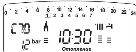
**Регулирование температуры воды в контуре ГВС**
