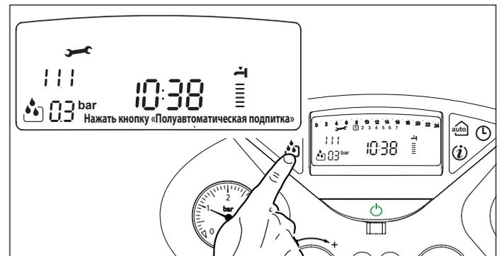
Котел следует перезапустить, а контур отопления подпитать, нажав кнопку "Полуавтоматическая подпитка".
