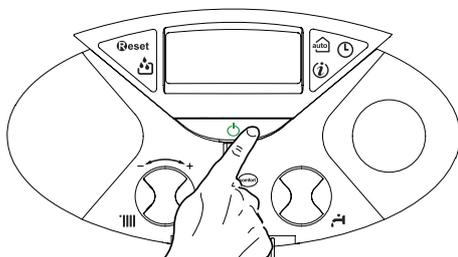
Полное выключение котла осуществляется переводом внешнего двухполюсного выключателя в положение OFF (ВЫКЛ); дисплей при этом гаснет. После отключения котла от сети электропитания закройте газовый кран.
